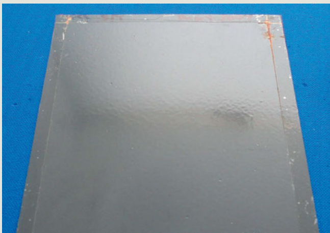
Abb. 5 // Stahlblech mit 25 µm Primer und ca. 80 µm Pulverlack nach 1.500 h im neutralen Salzsprühnebel nach DIN EN ISO 1227
