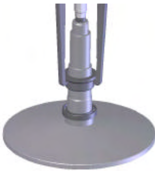
Retrait de la bague de serrage (1C)
